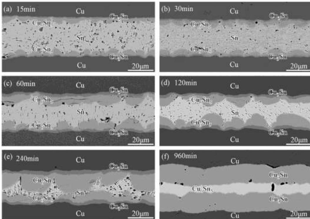
Morphology evolution in Cu-Sn intermetallic joints at 260 °C for various times: (a) 15 min, (b) 30 min, (c) 60 min, (d) 120 min, (e) 240 min, (f) 960 min.
